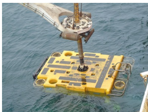
Sealion III 于 Wando-Jinsan 电力电缆后冲埋项目 (2017)
